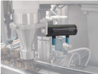
NTS 80 zum Befüllen von Fläschchen
