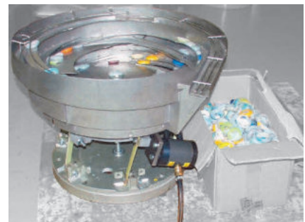
NTS 100/01 zum Wendelfördern von Schüttgut
