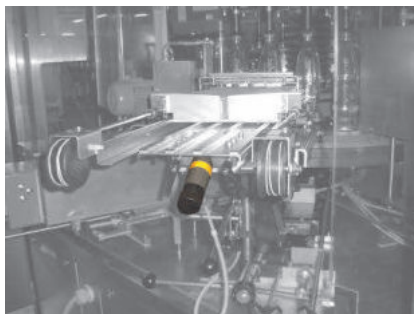
NTS 180 zum Etikettieren von Flaschen
