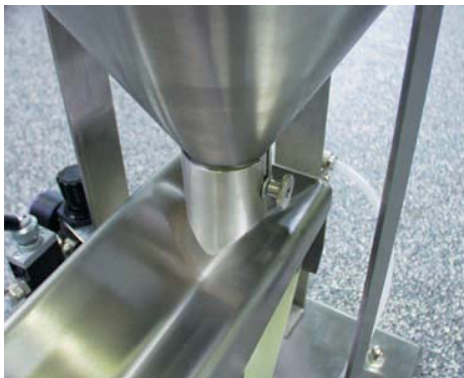
Dosierstützen am Behälterauslauf
