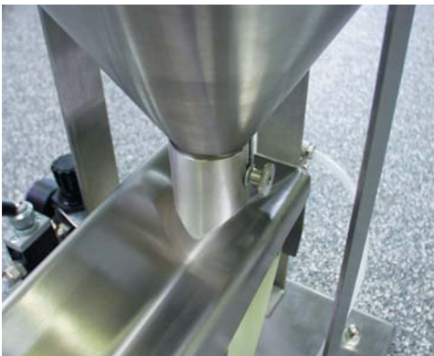
Dosierstützen am Behälteraustausch
