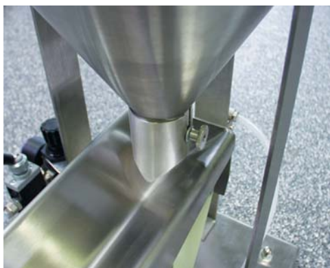
Regulowana długość końcówki wylotu zbiornika
