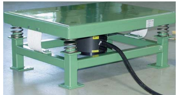
Compactage de produits poudreux en sacs
