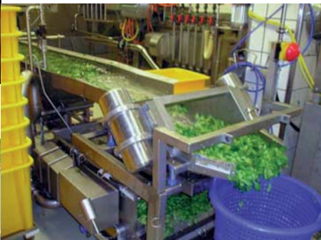
Convoyeur de criblage vibrant entraîné par des vibrateurs électriques externes en inox
