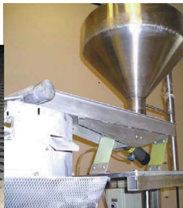
Точное подавание и дозирование сыпучих материалов при помощи вибрационного подавателя
