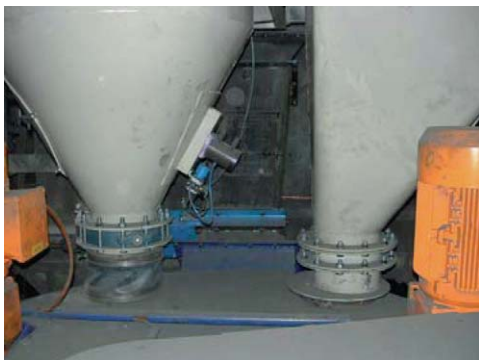
Удаление твердых налипаний при помощи пневматических поршневых вибраторов
