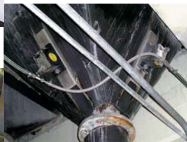
Удаление нависов при помощи пневматических вибраторов с круговой характеристикой колебаний
