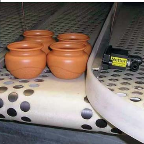
Распределение продуктов при помощи вибраторов с круговой характеристикой колебаний
