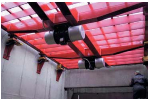
Просеивание крупнозернистых материалов при помощи электрических вибраторов
