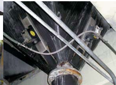
Vermeiden von Brückenbildungen mit Druckluft-Kreisschwingern
