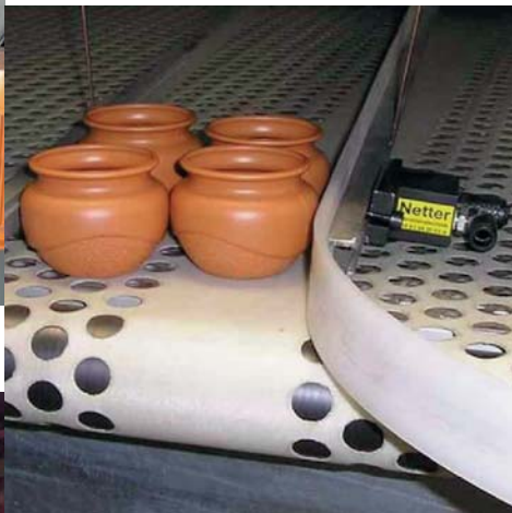
Vermeiden von Produktstaus mit Druckluft-Kreisschwingern
