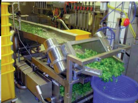
Fördersiebrinne, angetrieben mit Edelstahl-Elektro-Außenvibratoren
