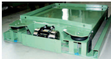
VTH/W 12/12 mit 2 NEG 501510 für eine Waage
