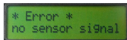
Fehlermeldung, falls kein Sensor angeschlossen wurde
