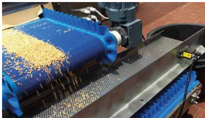
Hagebuttenkerne laufen nochmals über eine zweite Vibrations-Siebrinne, um die Kerne von möglichen Fruchtstückchen und Knäueln aus Hagebuttenhaaren zu befreien.
