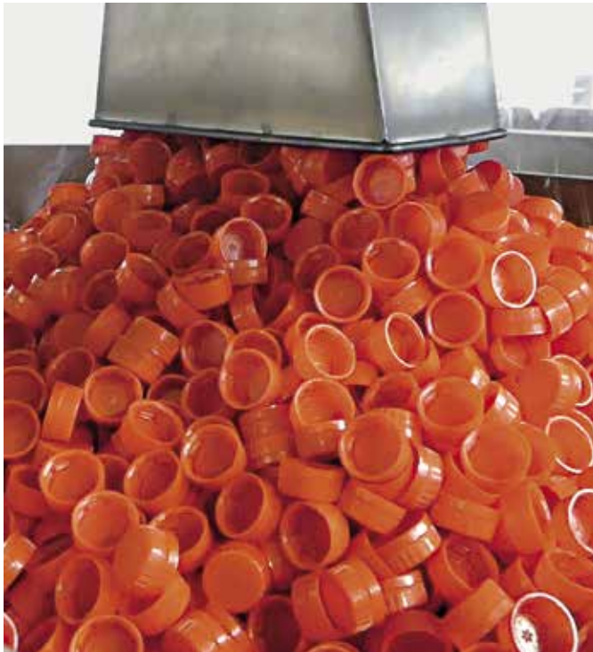
Schüttkegel von Kunststoffverschlüssen am Auslaufstutzen der Füllstation
